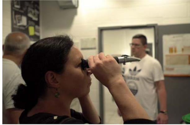
Nach Umfüllen und abkühlen wurde der Gehalt an Stammwürze mit dem Refraktometer bestimmt und durch Zugabe von Wasser auf 12.5 Grad Plato eingestellt.
